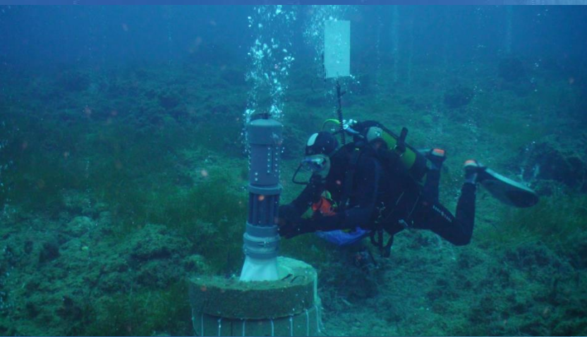
Taucher bei der Inspektion des submarinen Gasvolumenstrommessgerätes vor Panarea SDC TU Freiberg
